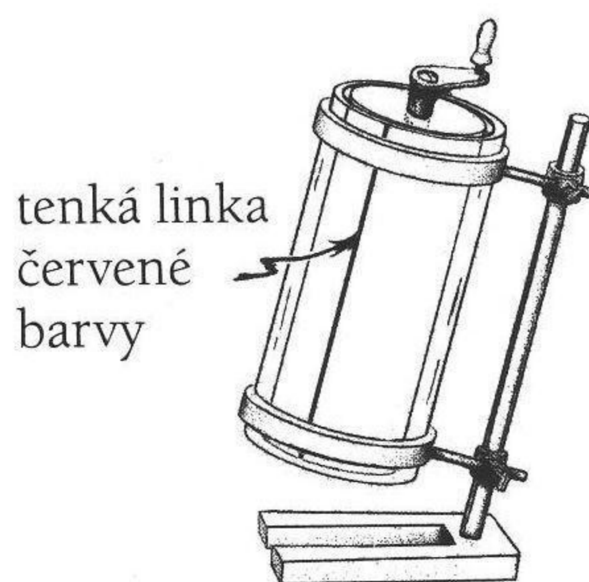
Obr. 1.13 Dvě skleněné, do sebe vložené válcové nádoby, mezi nimiž se nachází vazká tekutina a čára z červené barvy.
